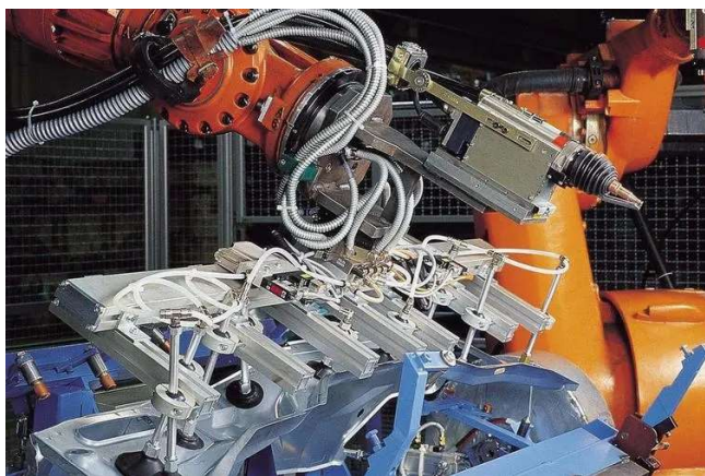
用于搬运气密和轻微透气工件的集成式真空发生器
